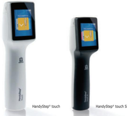
Distributeur à répétition avec écran tactile en couleurs et reconnaissance automatique de la taille. Grâce à la reconnaissance automatique de la taille des pointes PD-Tips II, avec codage breveté sur le piston, la taille de la pointe est affichée automatiquement après l'insertion. Le réglage de l'appareil est conservé après insertion d'une nouvelle pointe PD-Tips de même taille.
