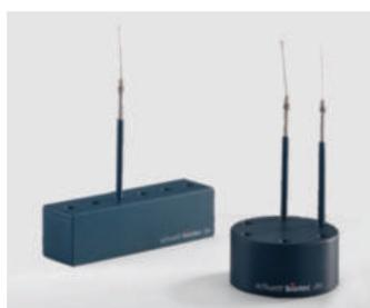
**Anse d'inoculation** pour chauffages à incandescence répétés. 3 matériaux différents : acier inox, fil spécial en acier inox ou en platine iridium (90/10). Excellents résultats en test de longue durée. Longueur : 60 mm. Diamètre du fil 0,5 mm.
