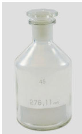
Pour la détermination de l'oxygène dissous dans l'eau. Le volume mesuré est indiqué à  $\pm 0,01$  ml près. Surface de marquage blanche. Pour éviter les erreurs, le flacon et le bouchon portent le même numéro.
