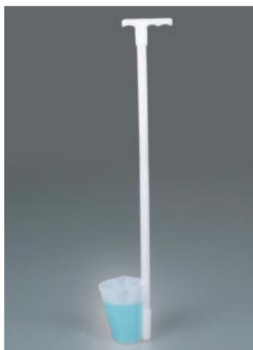
La louche graduée avec impression en relief permet de mesurer et d'afficher le contenu par pas de 10 ml, jusqu'à 200 ml.
