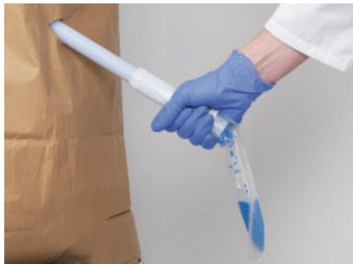
Pour un prélèvement d'échantillons sans contamination. Fabriqué en salle blanche, emballé individuellement. Versions stérilisées gamma disponibles en option.
