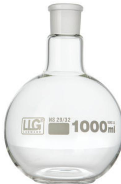
Avec fond plat et rodage normalisé. Graduation et inscription blanches. Conforme à DIN EN ISO 4797.
