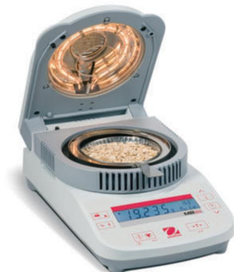
Les modèles MB23 et MB25 apportent des résultats précis pour une résolution de l'humidité de 0,1% ou 0,05%. Comme ils sont équipés au choix soit du système de chauffage infrarouge soit halogène, ils conviennent parfaitement pour de nombreuses utilisations différentes.
