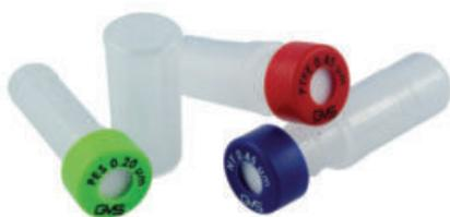
SEPARA intègre dans un seul appareil : flacon d'échantillonnage automatique, membrane de filtration, piston et bouchon/septa. Le process de filtration en une étape est efficace et économise du temps. Flacons en PP de Ø 12 x 33 mm, volume de filtre 0,48 ml, volume mort <30 µl, température de travail maximale 50 °C
