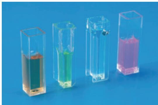
Cuves jetables pour la spectroscopie en PS ou PMMA pour une transparence optimale lors de l'utilisation de longueurs d'onde de 340 à 800 nm (PS) ou de 280 à 800 nm (PMMA). Tolérance de mesure de ±1%, ce qui est très important pour les examens de série !
