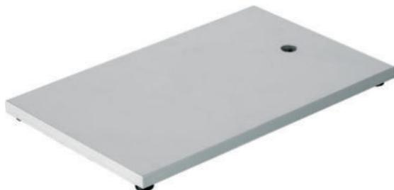
DIN 12892. Acier, thermolaqué. Epaisseur 8 mm. Pieds en caoutchouc. Avec un perçage taraudé M 10 dans le milieu du côté avant.
